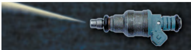
Фанел распыла до использования очистителя
