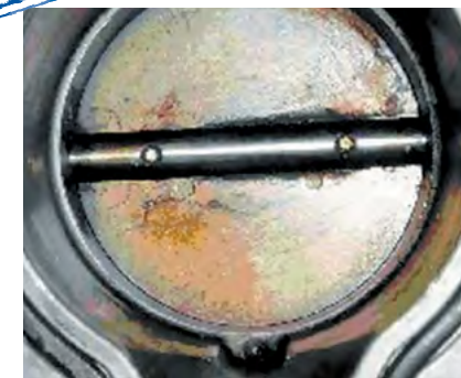
Внешний вид дроссельной заслонки после очистки HG3247
