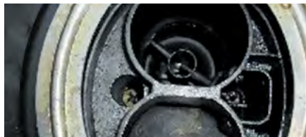
Карбюратор автомобиля до очистки HG3116
