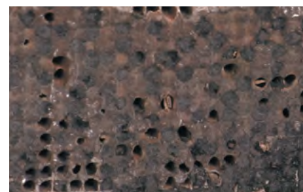
Низкооктановый бензин вызывает оплавление нейтрализатора
