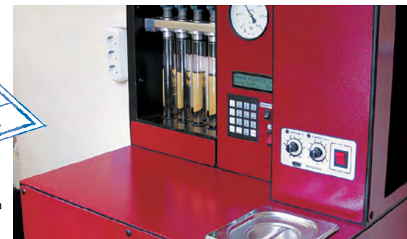
Рис. 1. Интегральная установка для тестирования моющих присадок к топливу
